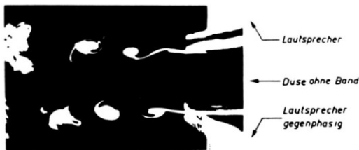
Fig. 7. Ebene Freistrahlgrenzschichten (mit Rauch sichtbar gemacht) bei akustischer Beeinflussung durch zwei gegenphasige Lautsprecher ober- und unterhalb des Strahls. Strahlgeschwindigkeit U_0 = 2 m/s; Schallfrequenz f = 30 Hz.
